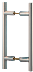
Paire de poignées inox brossé Ø 14 mm entraxe 148 mm, longueur totale 192 mm Pair of stainless steel handles Ø 14 mm, centre distance 148 mm, total length 192 mm
